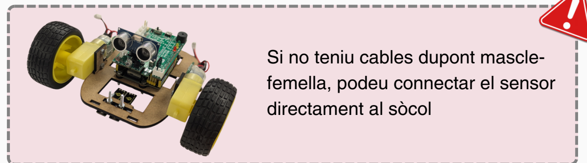
9 Connecteu el sensor d'ultrasons. A l'exemple, Echo: D2 i Trig: D4.
